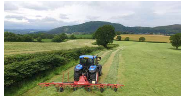
A termelékenység növelése érdekében ezek a rendterítők mechanikus határszóró rendszerrel vannak felszerelve. Opcionálisan hidraulikus megoldás is elérhető. Egy indikátor pontosan mutatja a tengely helyzetét.
