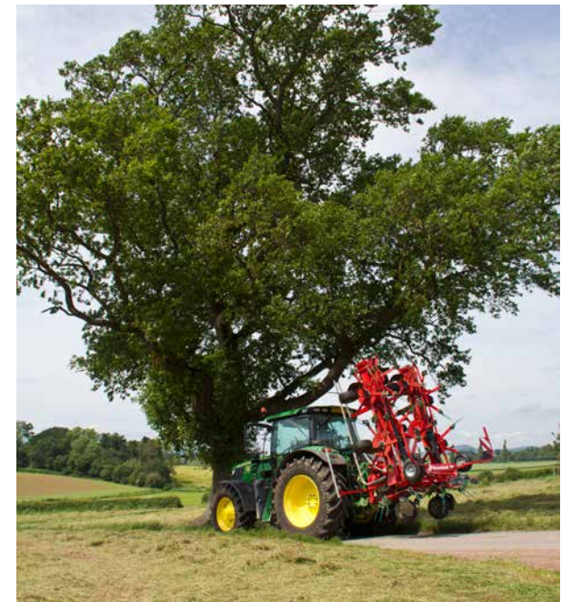
A Kverneland 85112 kompakt szállítási méretei - a tárolási magasság csak 3.80m.
